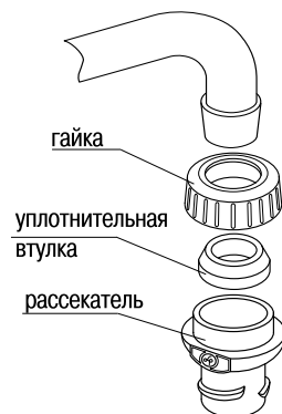
Рис. 2. Установка переходной втулки для гладкого крана.
