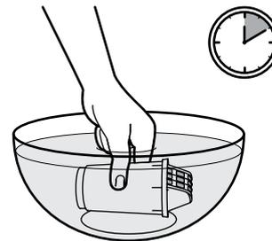
Распакуйте новый модуль и погрузите в холодную воду на 10 мин.
